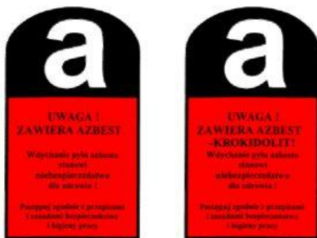
Oznakowanie wyrobów i odpadów zawierających azbest
